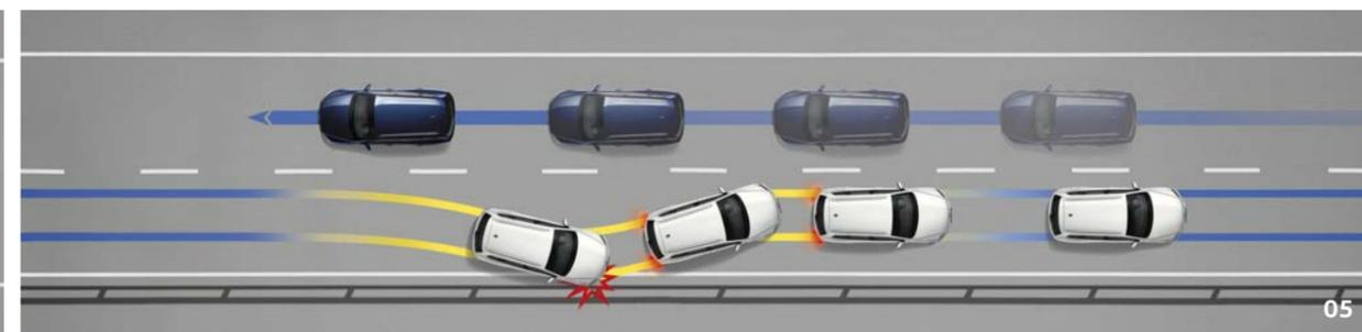
**03** El **asistente de mantenimiento de carril "Lane Assist"**: a partir de una velocidad de 65 km/h, una cámara detecta si el vehículo se desvía inadvertidamente de un carril de circulación marcado. Tras su activación, en este caso el sistema avisa mediante vibración del volante.\* | o
